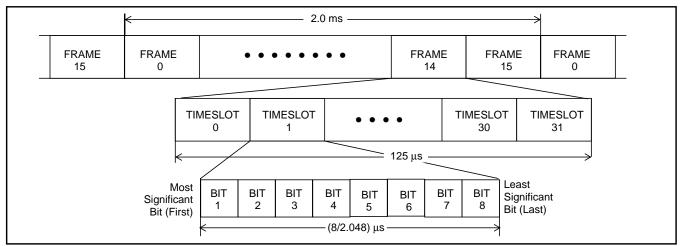
Figure 68 - DS1 Link Frame Format (E1)
